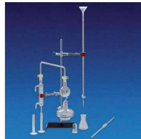
1 | Fabricado en vidrio borosilicato con uniones esmeriladas 14/23.
