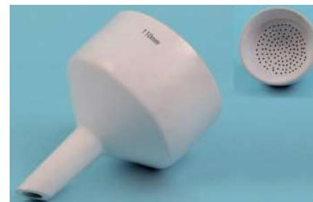
1| Utilizados en procesos de filtración al vacío.
