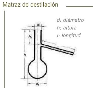
Pieza de vidrio especialmente diseñada para realizar el proceso de destilación simple mediante la conexión de un refrigerante al brazo lateral y un termómetro de control en la boca.
