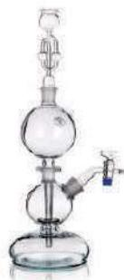
El aparato de Kipp, también llamado generador de Kipp, es empleado para la generación de pequeños volúmenes de gas (CO<sub>2</sub>, H<sub>2</sub>S, H<sub>2</sub>, O<sub>2</sub>, etc.) a temperatura ambiente.
