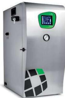
1 | Equipo automático para producir agua ultrapura, provisto de un circuito de recirculación con un módulo de intercambio iónico TOC, un módulo de fotooxidación de 254 nm (lámpara UV) y una cápsula de microfiltración en cascada de 0,45/0,2  $\mu\text{m}$ . El agua purificada obtenida cumple los requisitos de la norma EN ISO 3696: 1999 (Agua para uso en análisis de laboratorio. Especificación y métodos de ensayo.) para aguas de grado 1.
